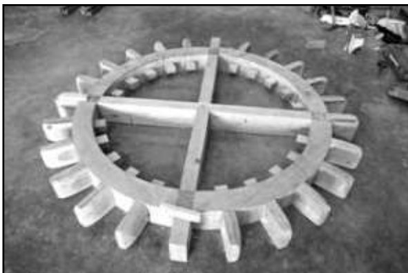
Figuras 6 y 7. Fabricación de rueda de molino. Ajustes en taller.
