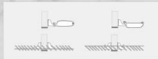
Disposición súpera (izquierda) e ínfra (derecha)
