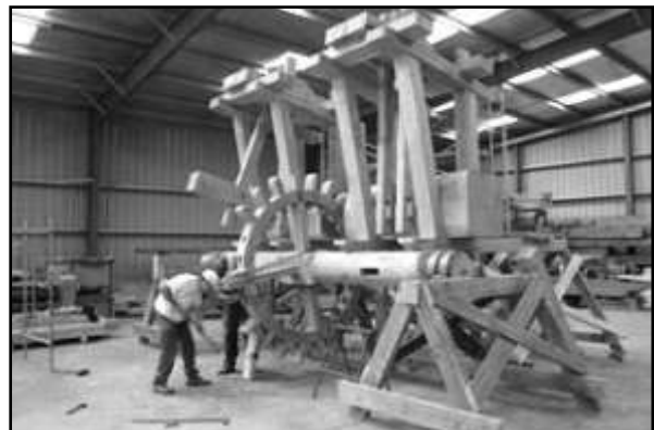
Figuras 6 y 7. Fabricación de rueda de molino. Ajustes en taller.
